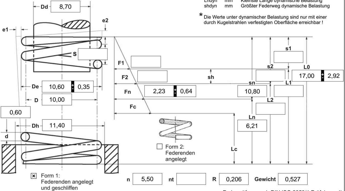
Federprüfung nach DIN ISO 2859/1 Prüfniveau II
