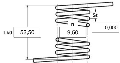
Federprüfung nach DIN ISO 2859/1 Prüfniveau II
